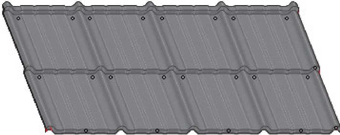
26GA. STEEL ESTIMA 16 FASTENERS/PANEL
