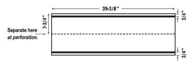
STARTER STRIP SHINGLE, TRI-BUILT SHINGLE STARTER, SRS TOPSHIELD
